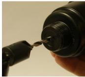
Le filtre peut être utilisé avec ou sans purge. Pour utiliser la purge fournie : percer le fond de la cuve à l'axe de l'embout fileté à l'aide d'une mèche de 16 mm.
