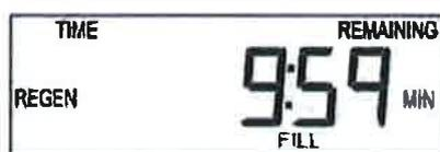
*L'eau cesse de couler par le tuyau de vidange et le bac à saumure se remplit.
