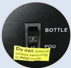
Enlever l'étiquette jaune [REDACTED] à l'arrière de l'appareil se trouvant sur l'interrupteur et vérifier que celui-ci soit bien en position **ROU**, sinon l'y mettre. Puis remettre l'étiquette afin d'indiquer qu'il ne faut pas changer de mode.
