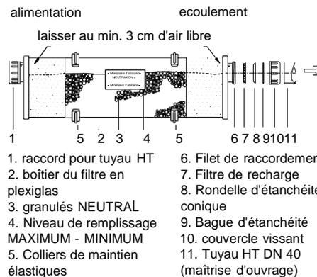
**Les ouvertures d'alimentation et d'écoulement ne peuvent être entièrement couvertes de granulés afin d'éviter toute congestion.**
