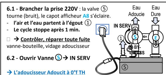
**7 - RINCAGE RESINE ET TEST REGENERATION**
